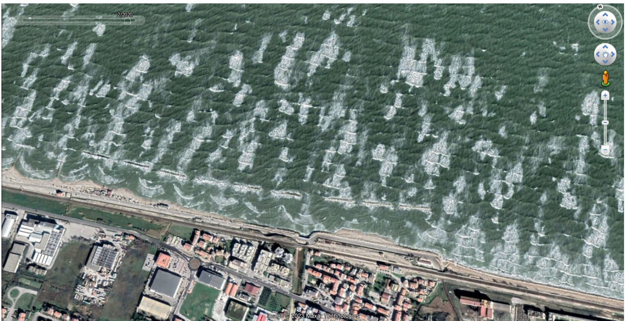
Fig. 4.2 Diffrazione ed overtopping in presenza di scogliere emerse durante una mareggiata
