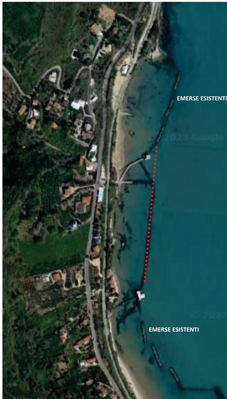
Fig. 4.4 Tratto di intervento litorale Nord di Fossacesia con barriere foranee emerse
