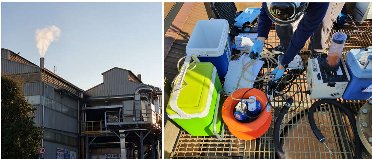
FOTO 6, FOTO 7: CAMINO A5 E PARTICOLARE OPERAZIONI DI CAMPIONAMENTO
