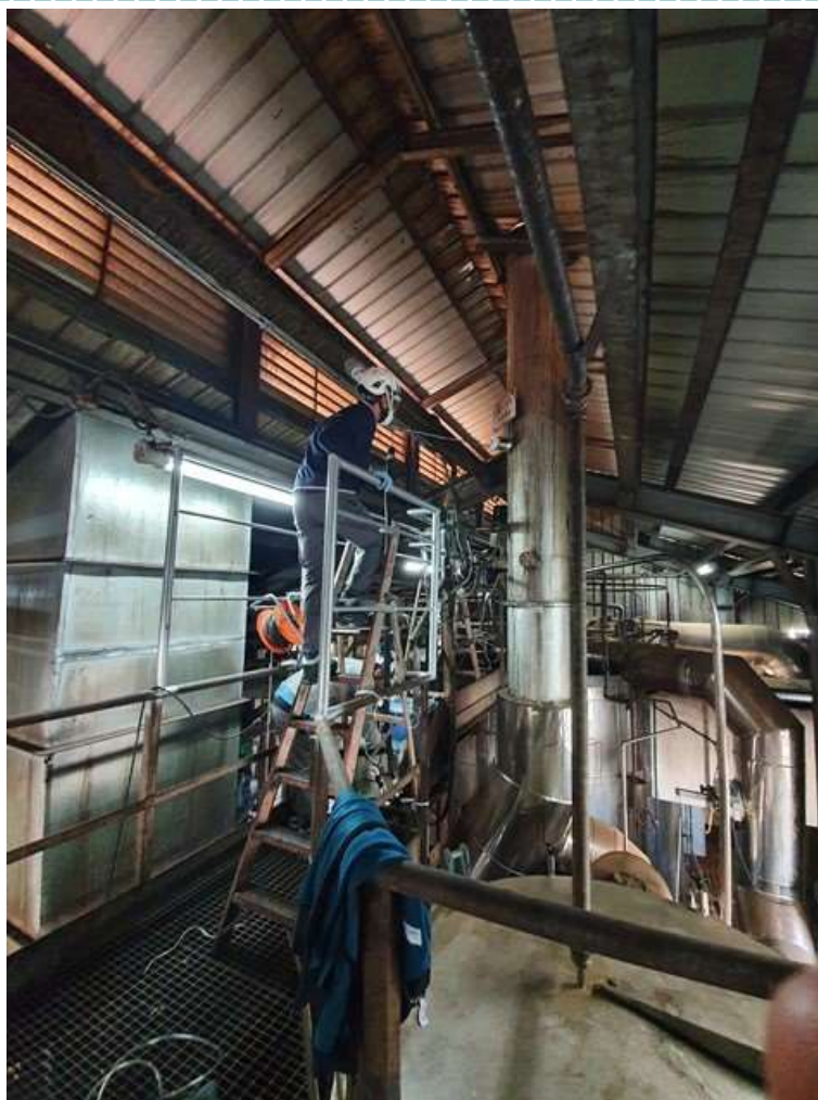
FOTO 9: ATTIVITÀ DI CAMPIONAMENTO AL CAMINO A11 ESSICCATORE
