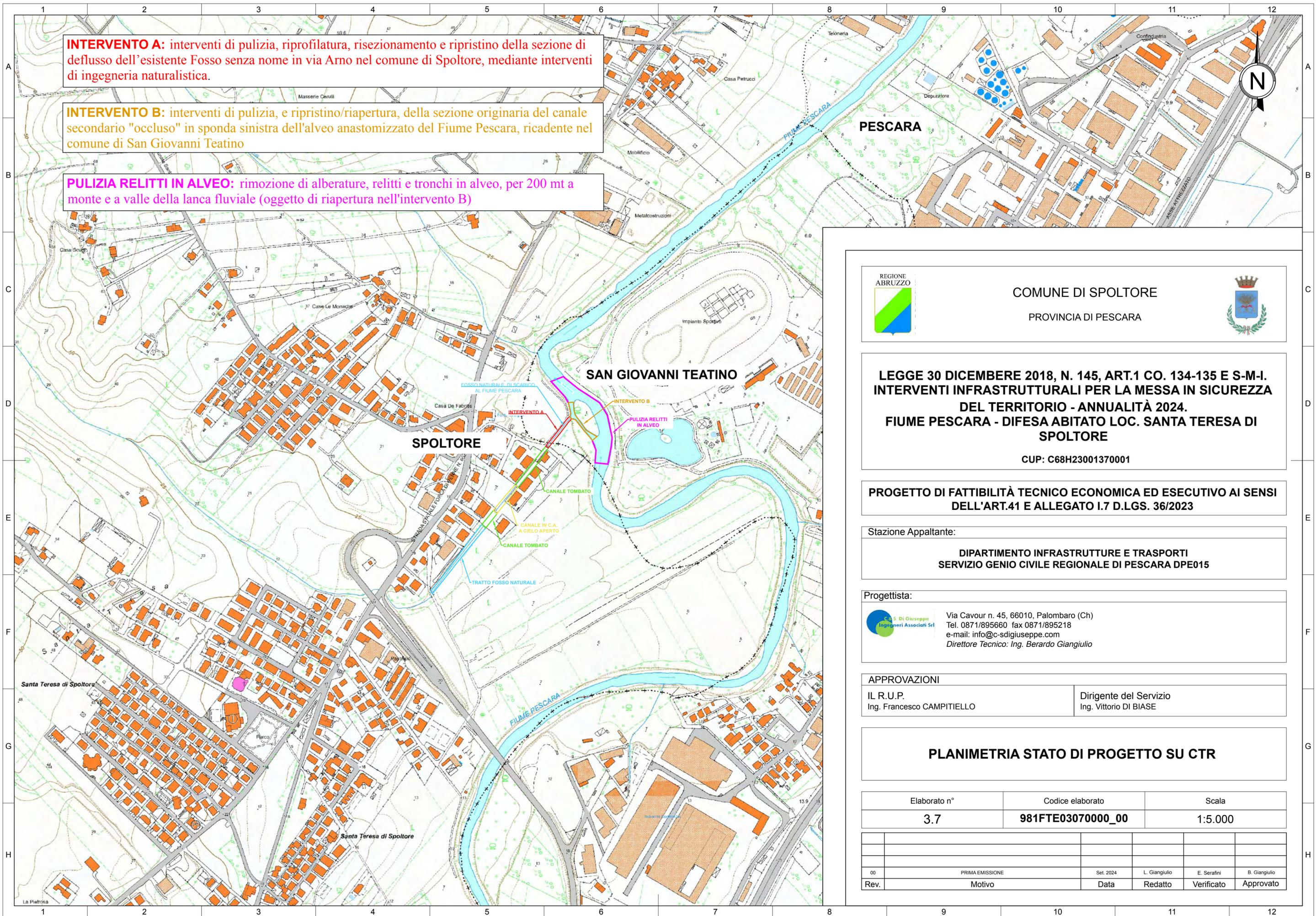
**INTERVENTO A:** interventi di pulizia, riprofilatura, risonamento e ripristino della sezione di deflusso dell'esistente Fosso senza nome in via Arno nel comune di Spoltore, mediante interventi di ingegneria naturalistica.
