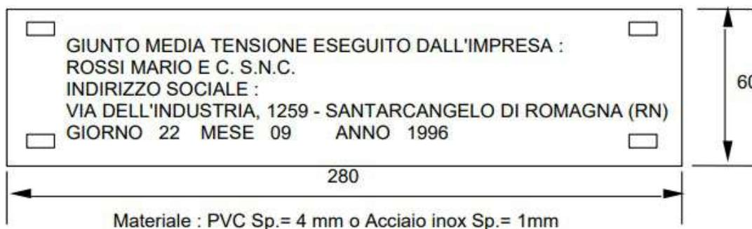
Figura 3 Esempio di targa identificatrice del giunto realizzato
