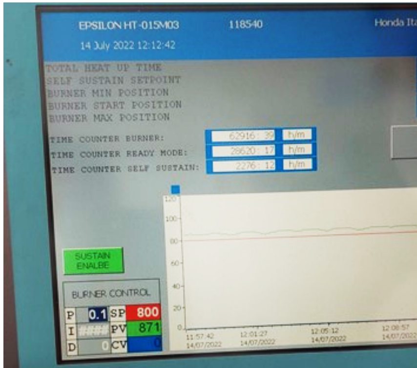
Foto 8: set point fissato ad 800°C come richiesto.
