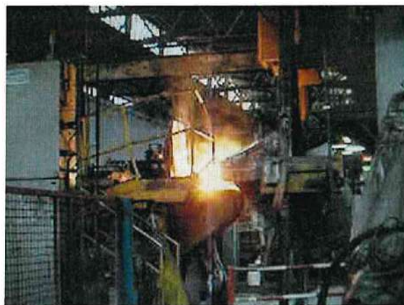
Fumi non captati del forno di colata
