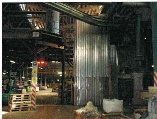
Area di produzione della ghisa sferoidale con apposizione di pannellatura
