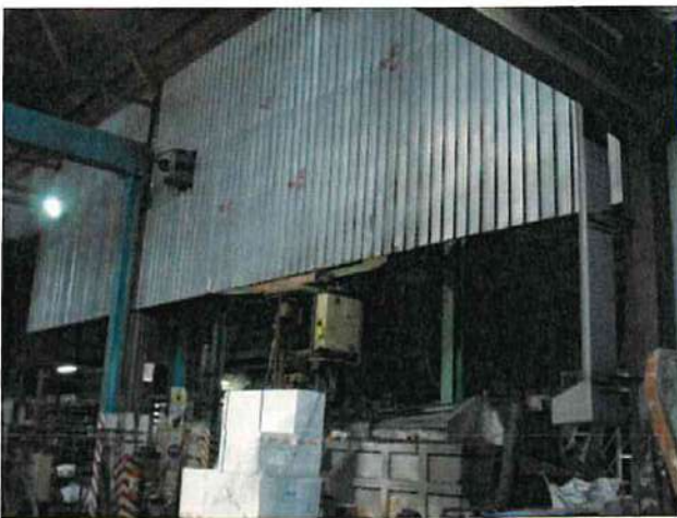
Area fusoria e di spillaggio dei forni rotativi compartimentata mediante apposizione di pannellatura nella parte alta
