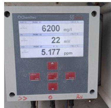
FOTO 7 – SONDE PER SOLIDI SOSPESI, OSSIGENO DISCIOLTO E POTENZIALE REDOX
