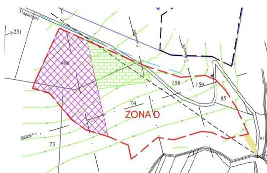
Area di progetto con perimetrazione dell'area interessata dai lavori il primo anno e dell'area adiacente dove sarà accumulato il terreno di scopertura
