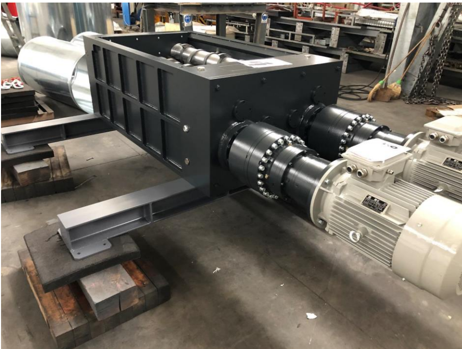
Foto della sezione laterale del trituratore con i motori degli alberi in evidenza
