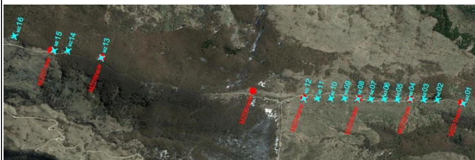
Fig. 2 – Stralcio aerofotogrammetrico (base Google), dove sono evidenziati gli aerogeneratori da dismettere ed i nuovi da installare.
