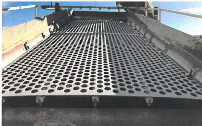
Istallazione nebulizzatori a bordo macchina (frantumatore)
