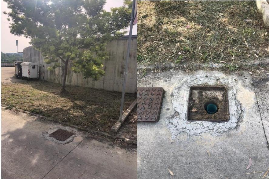
Figura 12 - Particolare piezometro P1
