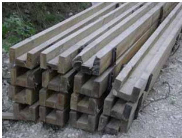
Figura 11 – Canalette trasversali in legno
