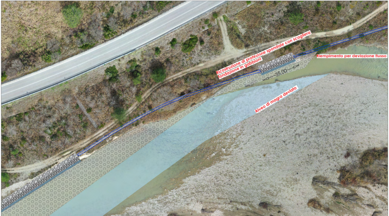
Sviluppo B - Lavori Aggiuntivi - Progetto Dettaglio Ricostruzione protezione spondale - Deviazione Alveo Scala 1:500
