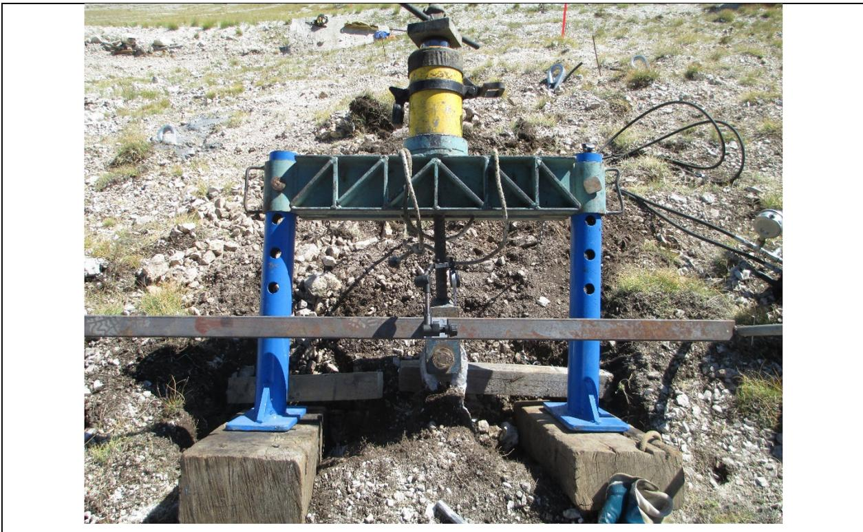
*Foto 6 Attrezzatura per prova su ancoraggi*
