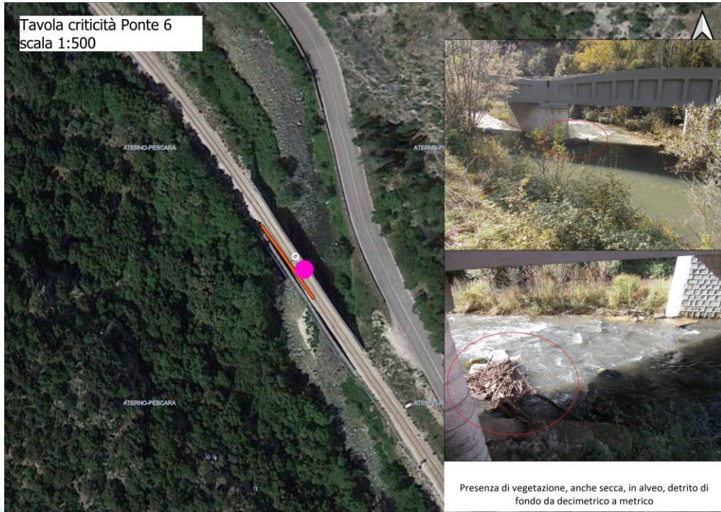
Figura 35 - Presenza di vegetazione, anche secca in alveo, detrito di fondo da decimetrico a metrico a ridosso del ponte 6.
