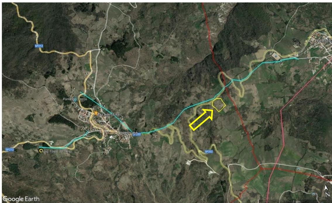
Figura 15 – Rappresentazione grafica su ortofoto a colori dell'adduttrice idrica Torrebruna (in azzurro) con identificazione del lotto d'intervento (in giallo)
