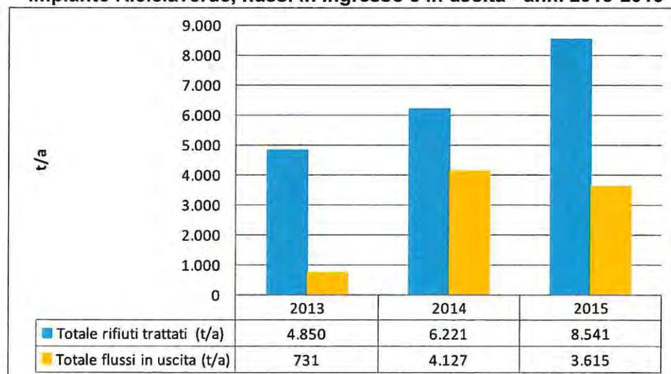
Di seguito si riportano i bilanci di massa dell'impianto di compostaggio per l'ultimo triennio. I rifiuti prodotti hanno elevata variabilità: il 15% nel 2013, il 6% nel 2014 e il 49% nel 2015; di conseguenza sono estremamente variabili anche le perdite di processo che, in media, sono nell'ordine del 60%.
