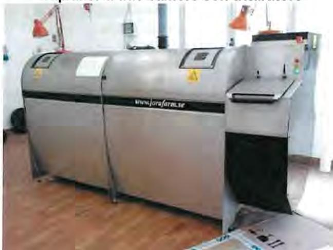
Nei sistemi a camera unica vi è un unico contenitore cilindrico; il materiale viene movimentato attraverso la rotazione del cilindro più interno o attraverso braccia meccaniche. Il materiale rimane dentro l'impianto per circa 40 giorni.
