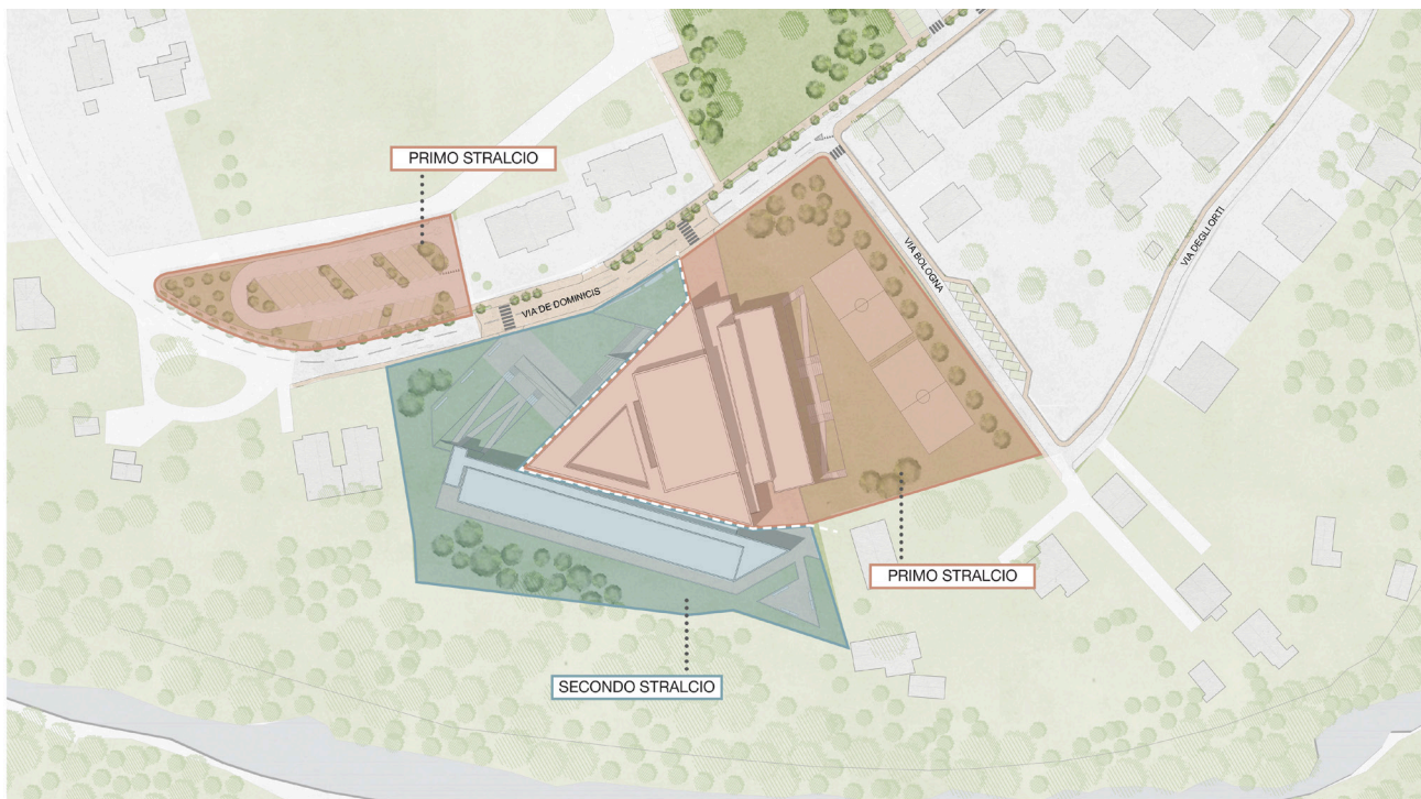
fig. 10 Divisione del progetto in due stralci successivi. Ogni volumetria sarà dotata di ingresso autonomo.
