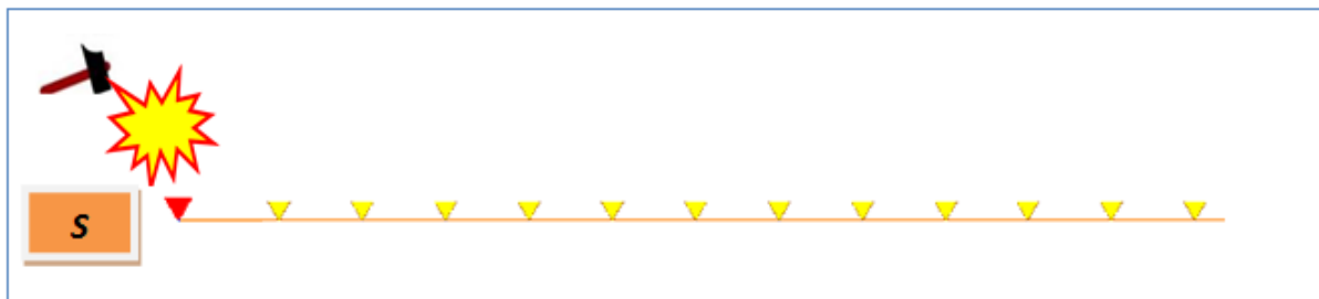
Fig. 4 - Stendimento sismico per i primi 12 geofoni, rappresentati in giallo e posti a distanza costante di 2 m. A sinistra del trigger è posta la massa battente che costituisce la sorgente di energizzazione; a destra è collocato il sismografo per la registrazione dei segnali sismici.
