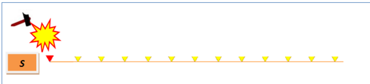
Figura 3 - Stendimento sismico per i primi 12 geofoni, rappresentati in giallo e posti a distanza costante di 1.0 m. A sinistra del trigger è posta la massa battente che costituisce la sorgente di energizzazione; a destra è collocato il sismografo per la registrazione dei segnali sismici.
