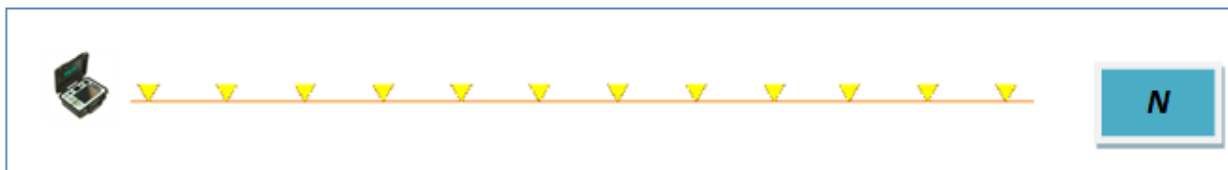
Figura 4 - Porzione terminale dello stendimento sismico (speculare all'array di 12 geofoni della Figura precedente).
