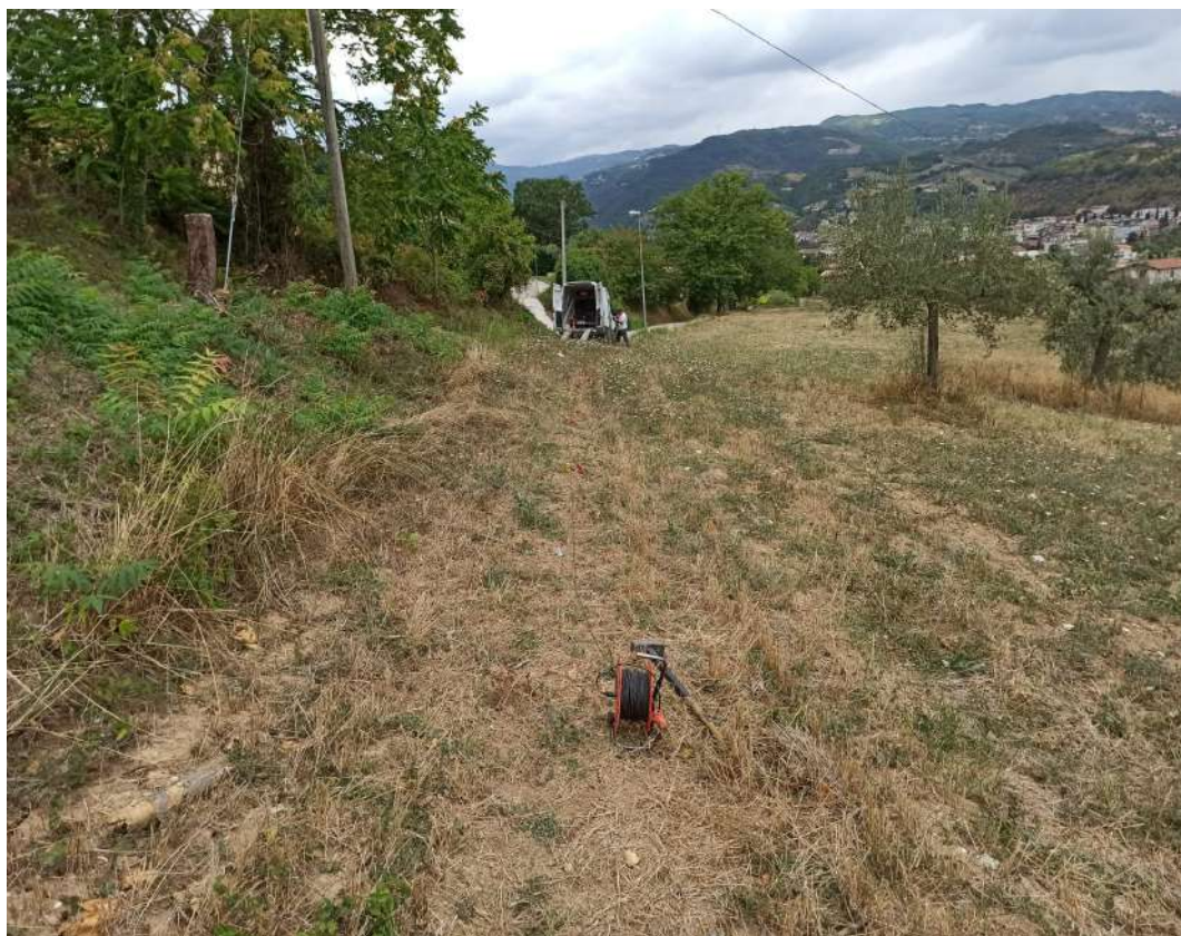
Prova sismica MASW
