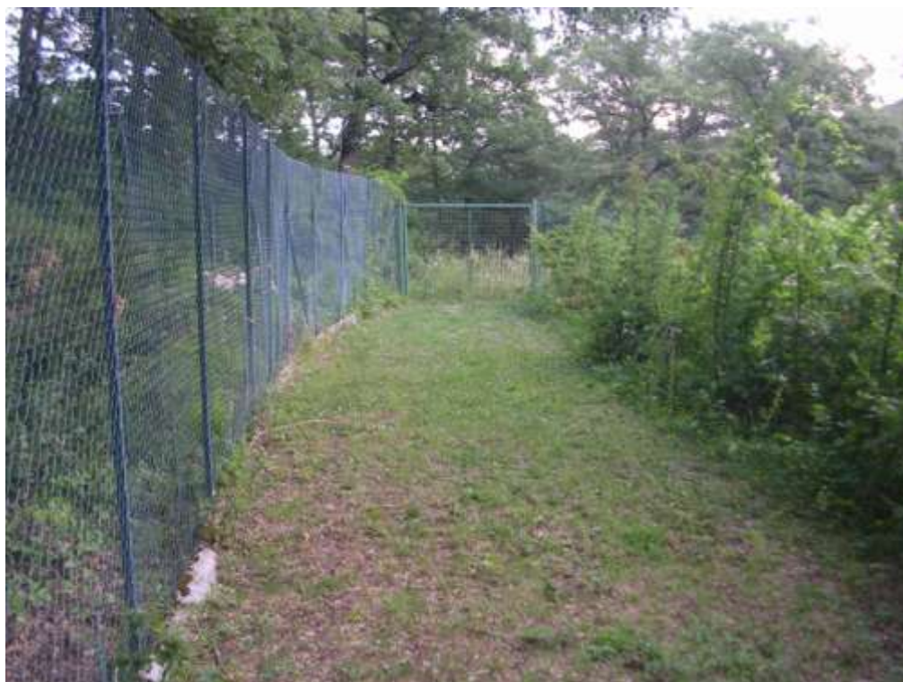
FOTO 13 – 16: strada interna che separa il campo da mini golf, dall'area boscata. Si noti il fondo naturale, la recinzione in rete e pali metallici con cordolo di cemento e il cancello di accesso a proprietà altrui posto al confine della proprietà SITI.
