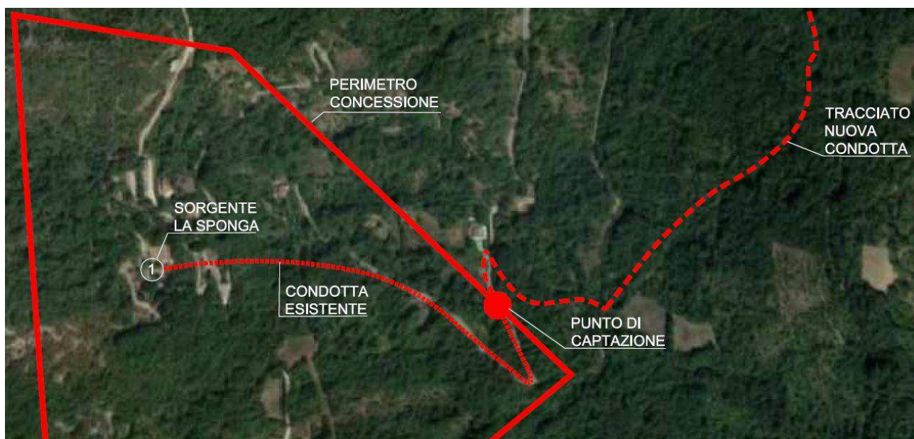
Figura 11 – Estratto dalla Tavola A7 di inquadramento generale del tracciato di condotta in progetto, con punto di raccordo tra la condotta preesistente e la nuova condotta prevista.
