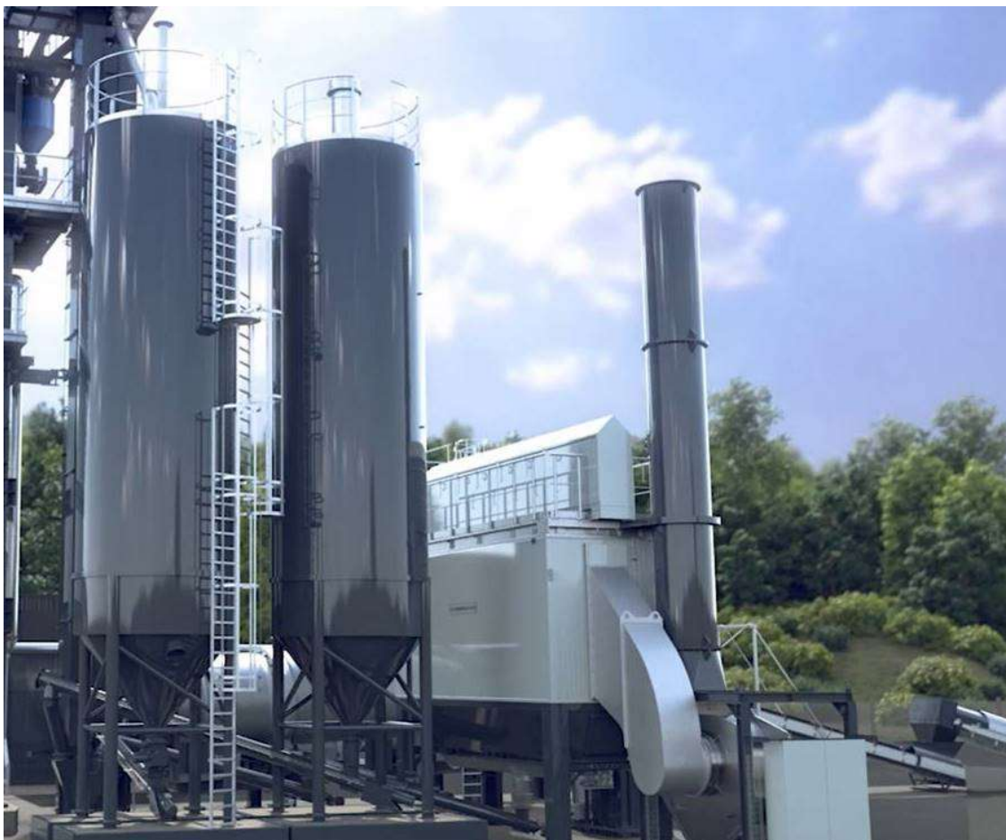
Figura 5 – Filtro e sili filler.
