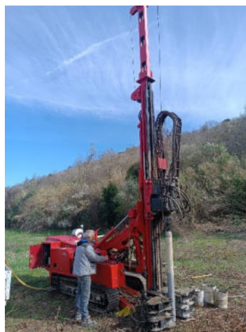
Sonda perforatrice tipo "EGT 900" - Sondaggio a carotaggio continuo.
