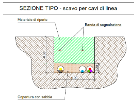
Disegni sezioni tipo da progetto per scavo plinto di linea e cavi di linea
