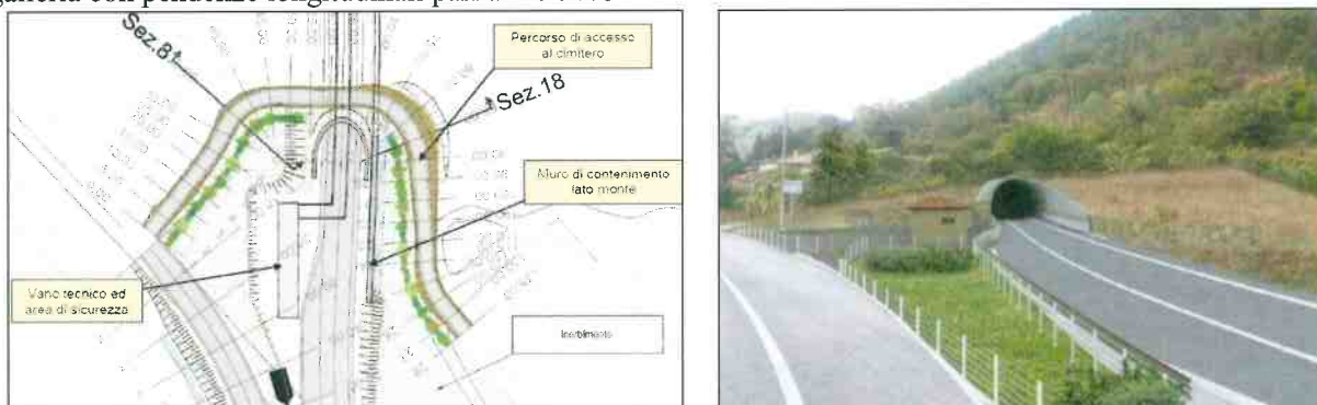
Fig. 11 – Configurazione PE e fotoinserimento nel contesto attuale (da Elab. S_01_01_01_05_T00EG00GENRE03C)
