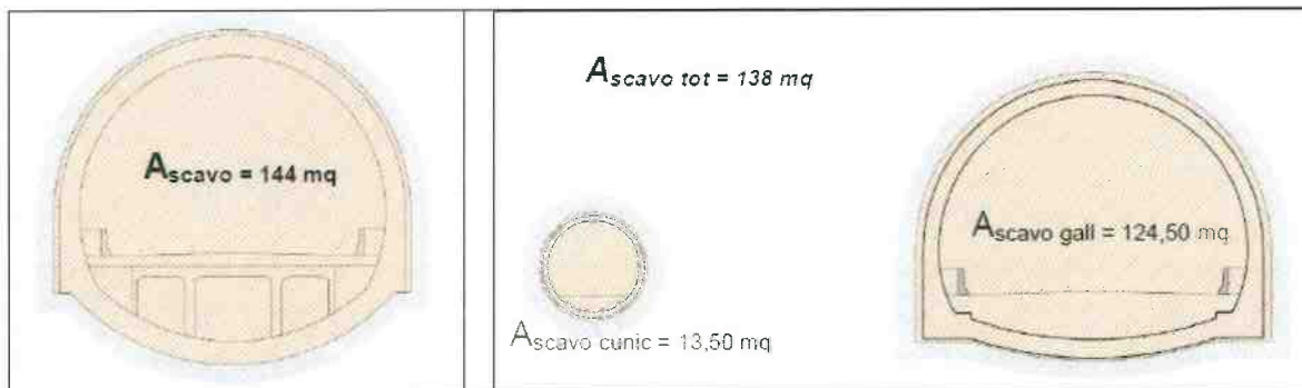
Fig. 10 – Confronto sezioni di scavo – Progetto Definitivo | Esecutivo (da Elab. S_01_01_01_05_T00EG00GENRE03C)
