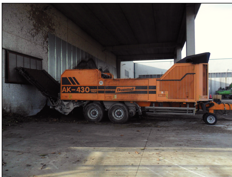
Figura 32: Trituratore dei rifiuti ligneocellulosici posto sotto tettoia in adiacenza all'area di ricezione
