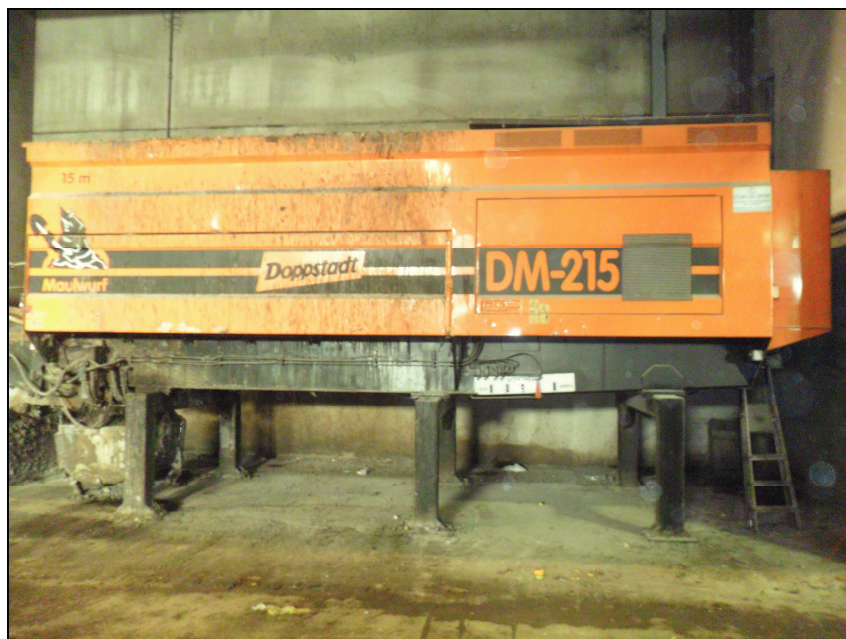
Figura 34: Miscelatore a coclee situato nell'area ricezione.
