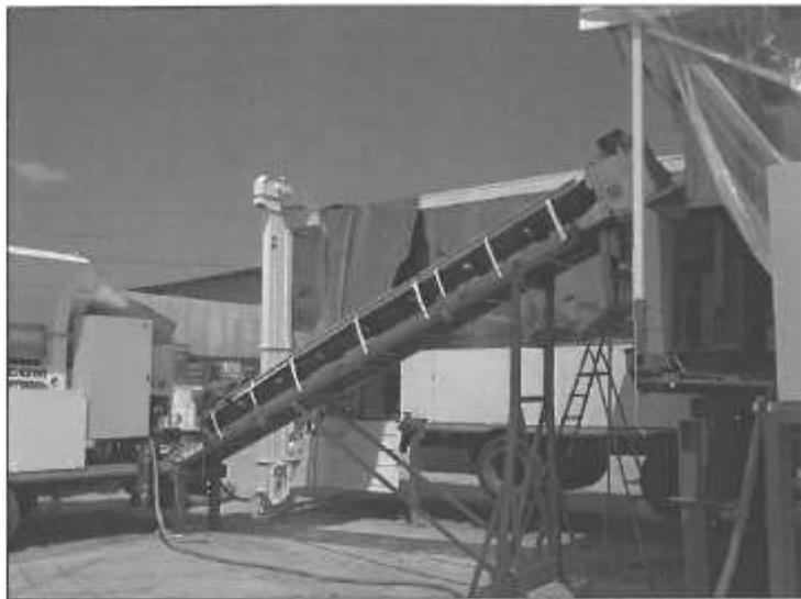
Foto 3. Nastro di alimentazione essiccoio
