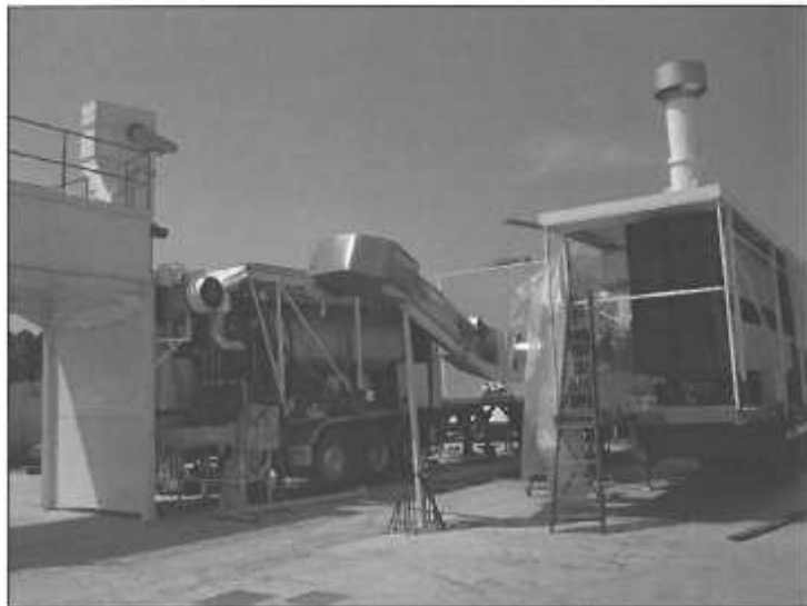
Foto 4. Essiccoio rotante e scambiatore di calore
