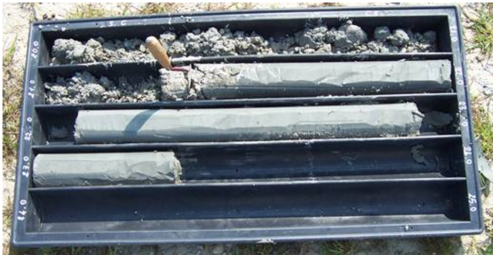
Passaggio ghiaie (acquifero) – argille (acquicluda dell'acquifero)
