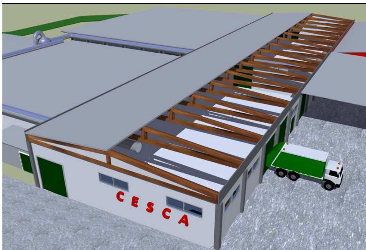
Figura 18: Capannone ricezione e trattamento, con capriate di legno trattato. Sotto le capriate è visibile la linea di aspirazione delle arie esauste.
