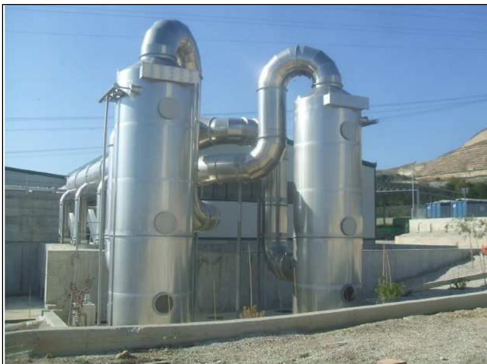
Figura 35: Torri di lavaggio (esempio).
