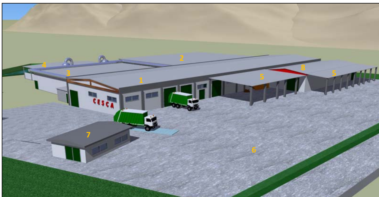
Figura 6: Rendering delle strutture in progetto: 1)Capannone ricezione e trattamento rifiuti; 2)Capannone maturazione; 3) Biocelle; 4) Biofiltro; 5) Tettoia carico ammendanti e triturazione rifiuti ligneocellulosici; 6)Pavimentazioni. Sono riportati gli edifici ristrutturati adibiti ad uffici (7) ed il capannone deposito ammendanti (8).
