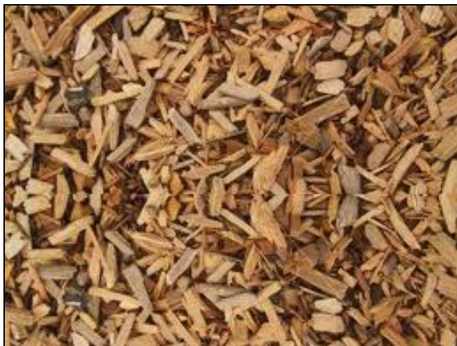
Figura 34: Particolare del materiale biofiltrante.
