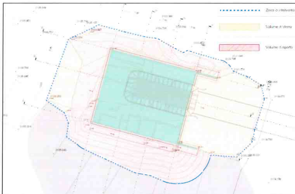
Figura 16: Stralcio planimetria di scavo stazione di monte (da elaborato 6.2.2).
