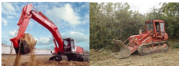
Figura 3.3 –Tipologie di mezzi d'opera previsti. Da sinistra: escavatore idraulico cingolato da 34 t, pala caricatrice cingolata da 110 HP.
