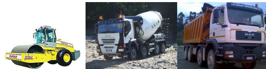
Figura 3.4 - Tipologie di mezzi d'opera previsti. Da sinistra: rullo compattatore vibrante da rilevati, autobetoniera per il trasporto del calcestruzzo, camion movimento terra.
