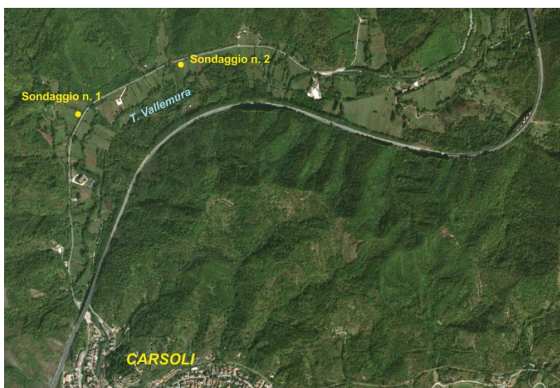
Figura 6.4 - Ubicazione dei sondaggi lungo il T. Vallemura con prelievo dei campioni di terreno e successiva analisi chimica.
