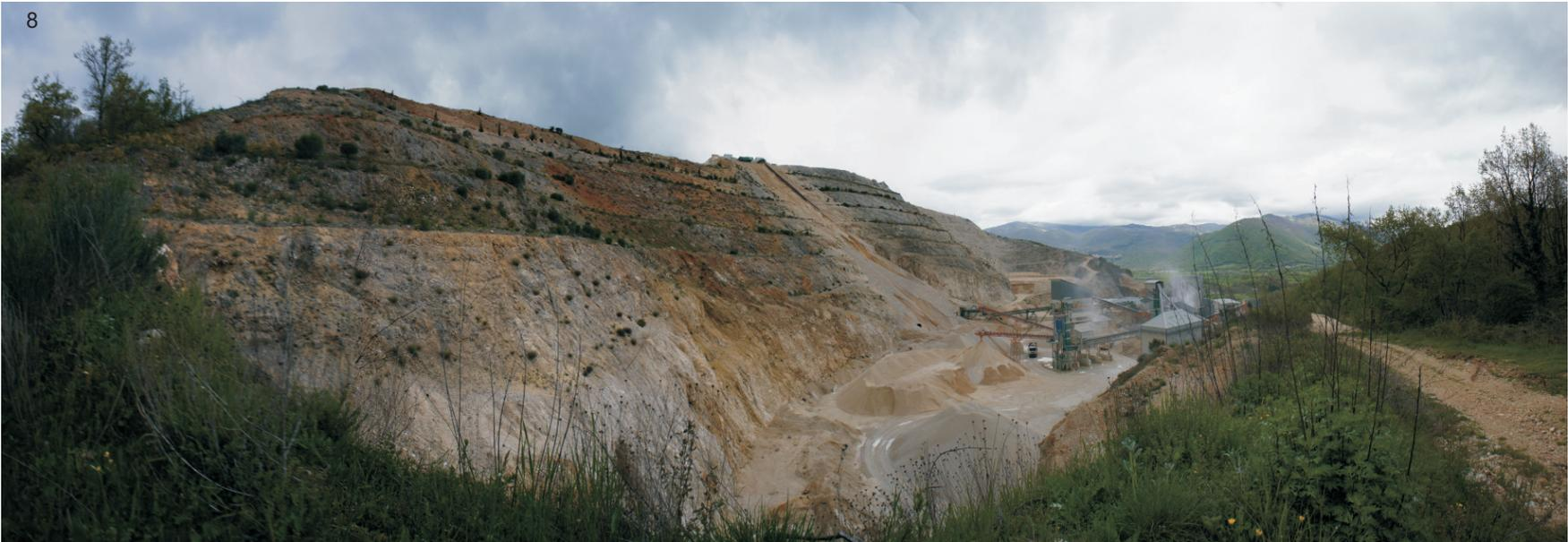
Una panoramica dello stato dei lavori nella cava, in evidenza nella parte centrale il sistema a scivolo per il trasferimento dai piazzali alti del materiale prelaborato verso il piazzale di fondo dove viene completato il ciclo di frantumazione e vagliatura e distribuzione nei cumuli delle pezzature merceologiche
