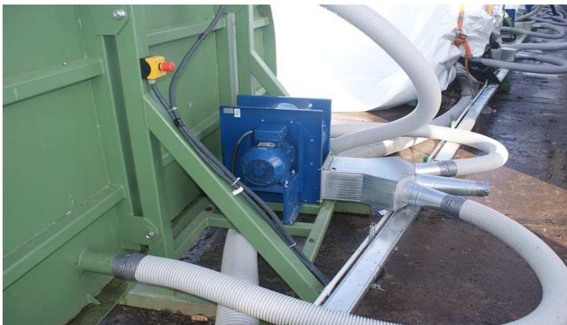
Foto 5: particolare delle dimensioni della soffiante e dei tubi di insufflazione (Ø 10 cm.)
