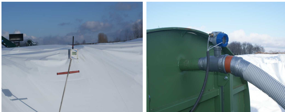
Foto 6: Sonda controllo temperatura (versione wireless) e sonda rilevamento Ossigeno residuo (versione cablata)
