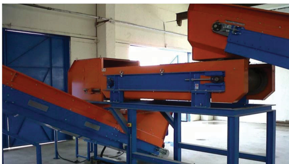
Figura 14. Separatore a correnti indotte (FOR REC s.r.l.)
