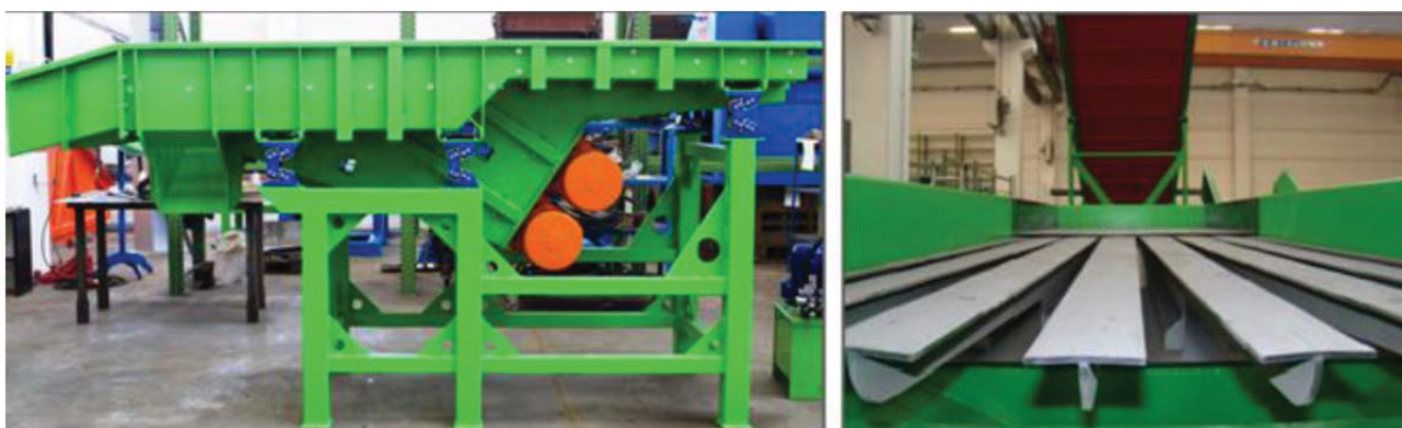
Figura 13. Trasportatore vibrante (FOR REC s.r.l.)
