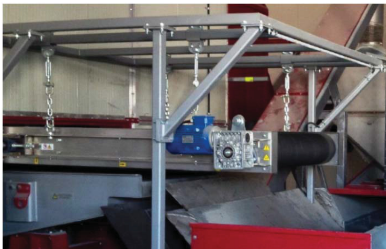
Figura 12. Separatore magnetico overbelt (FOR REC s.r.l.)
