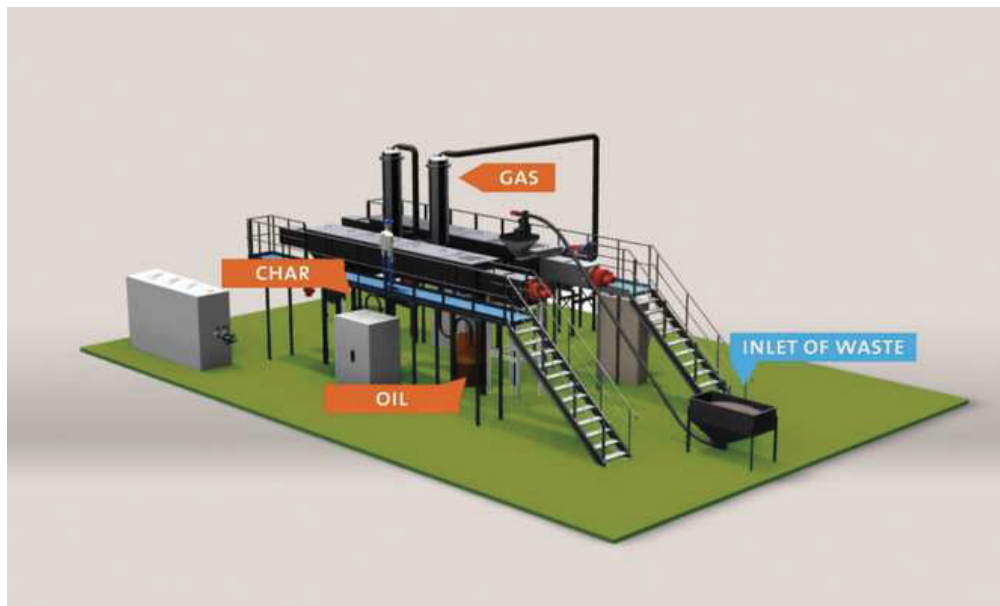
FIGURA 3_SCHEMA IMPIANTO PIROLISI
