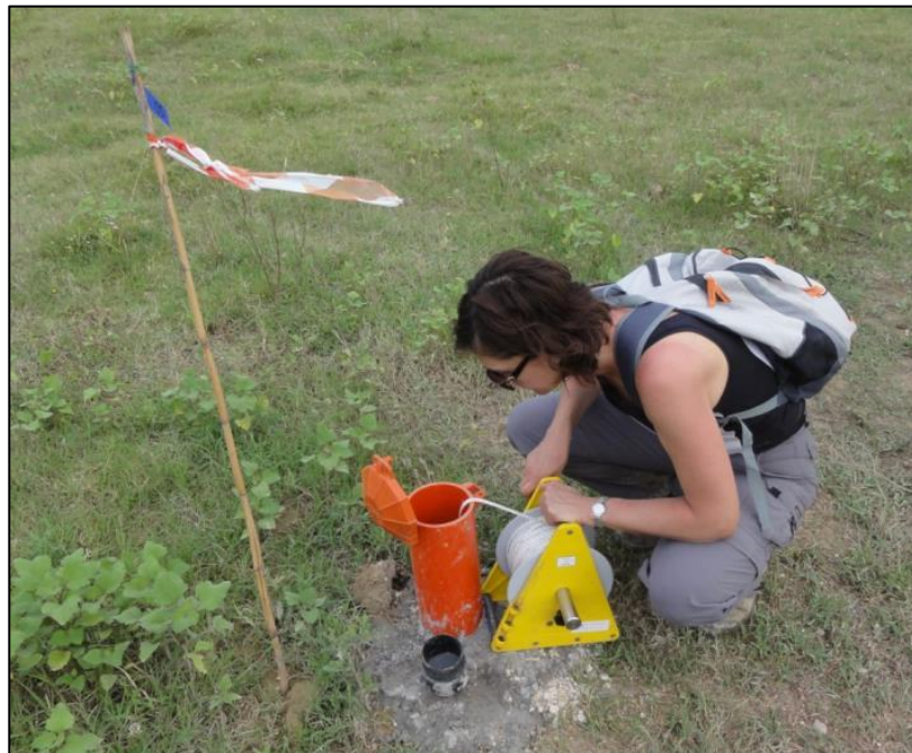
Figura 3.4 – Allestimento finale dei piezometri: tappo filettato e chiusino dotato di lucchetto.
