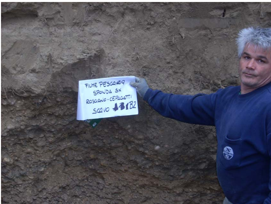
Scavo B2: particolare contatto stratigrafico sabbie - ghiaie sabbiose
