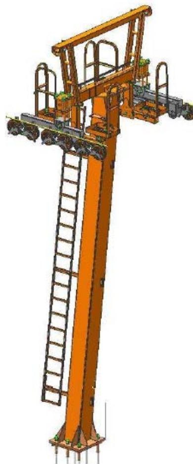
Fig. 20 – Esempio di sostegno in linea.
