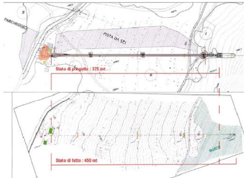
Fig.1 Confronto tra l'impianto di risalita in progetto (sopra) e quello esistente (sotto), l'accorciamento dal 450 mt a 375 ha consentito un arretramento dello stesso dal bosco.
