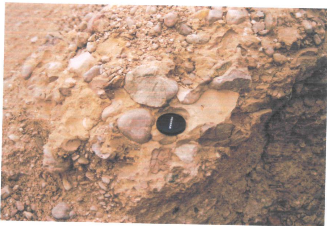
Foto n. 3: si può osservare la cementazione dei ciottoli che conferisce al litotipo un elevato grado di consistenza.
