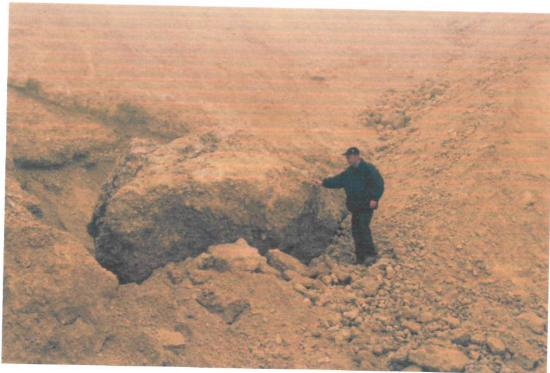
Foto n. 4: blocco conglomeratico di evidente consistenza lapidea staccatosi durante l'escavazione del fronte settentrionale della cava.
