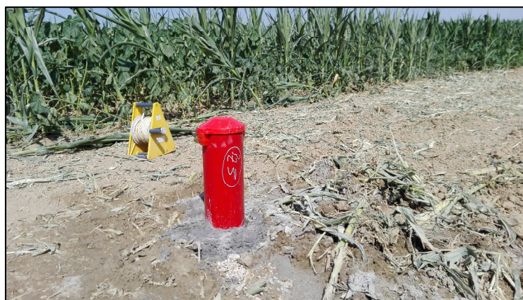
Fig.4– Pozzetto protezione strumentazione
