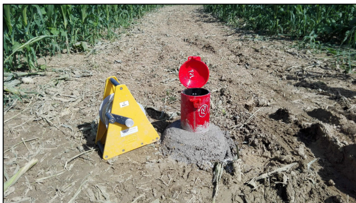
Fig.5– Sonda freaticometrica
