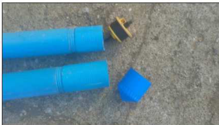
Fig.3 – Particolare piezometro
