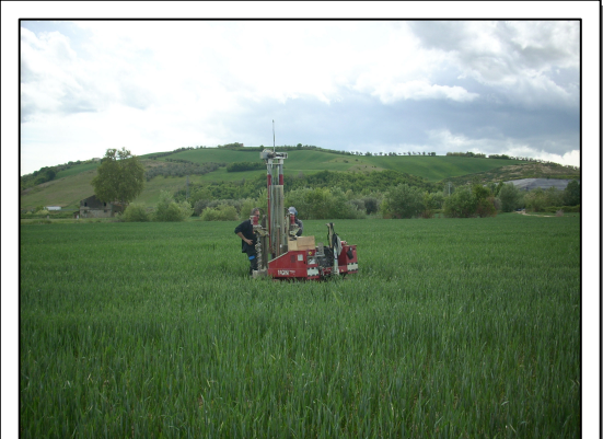
Esecuzione della prova penetrometrica dinamica
