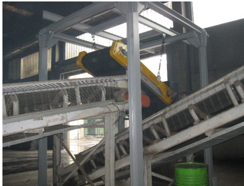
Esempio di separatore magnetico con struttura di sostegno
