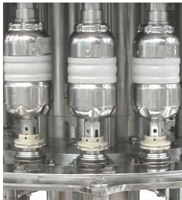
Fig. 8 Teste di tappatura
