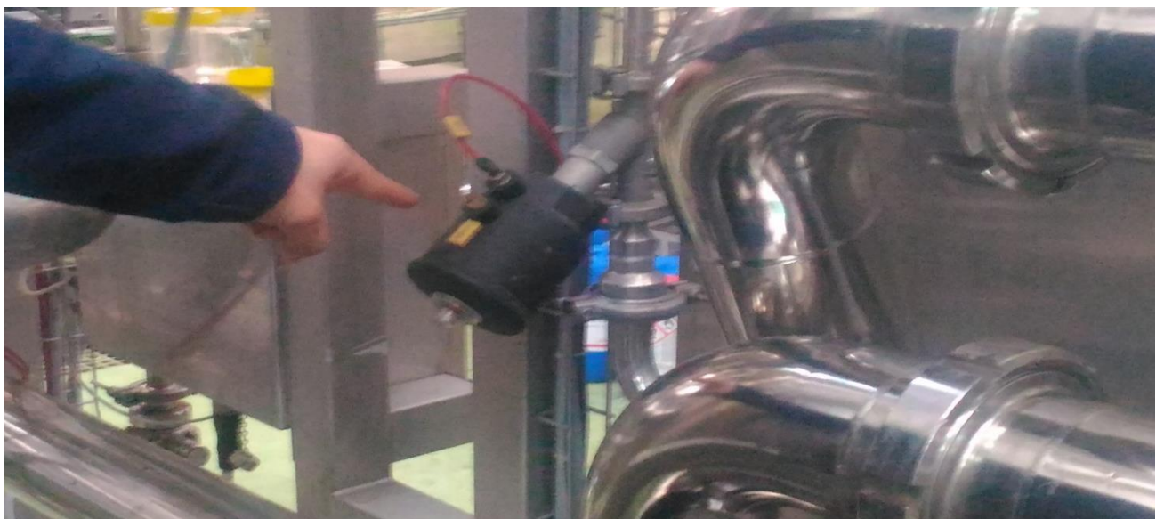
Fig. 2 Valvola di iniezione della CO 2 nel flusso di acqua minerale
