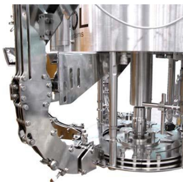
Fig. 7 Particolare slitta discesa tappi
