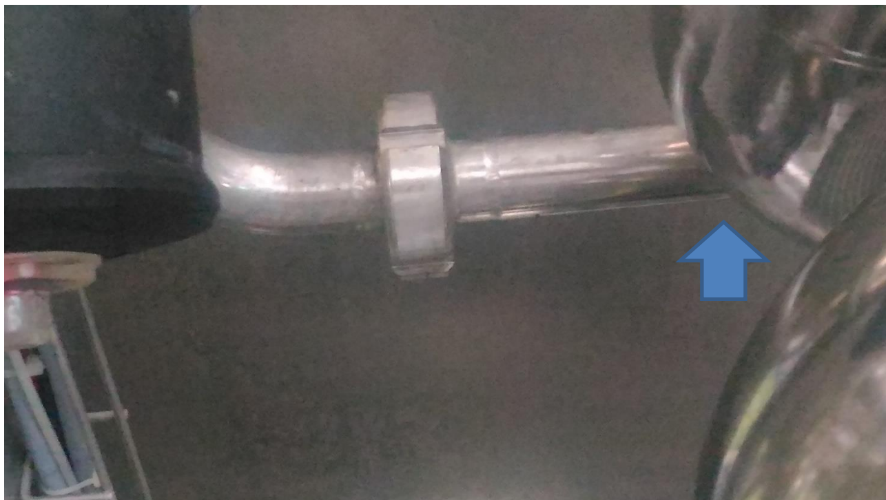
Fig. 3 Dettaglio del punto di iniezione della CO2 nel flusso di acqua minerale.
