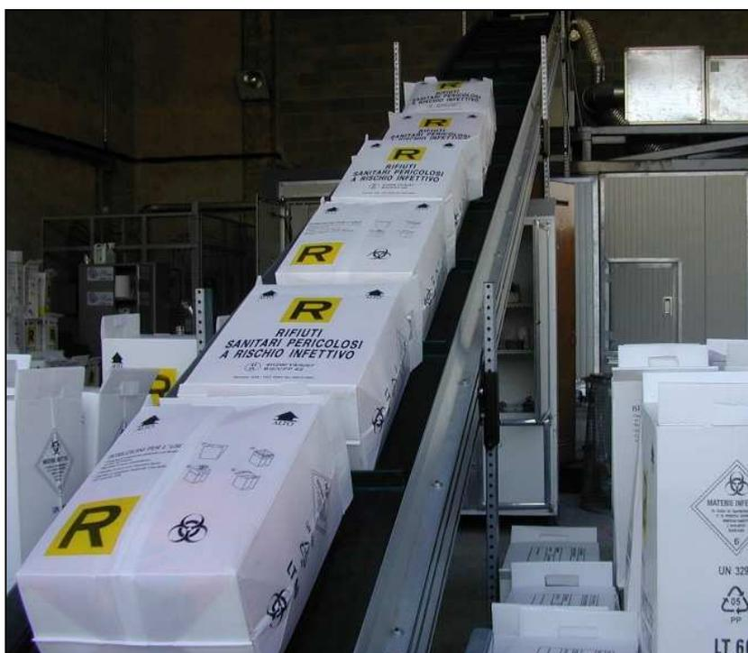
*Fig. 4. Nastro di carico analogo a quello previsto*
