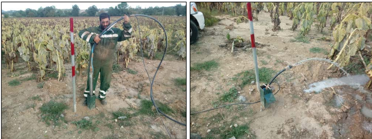
Fig.3: Fasi dello spurgo dei piezometri.
